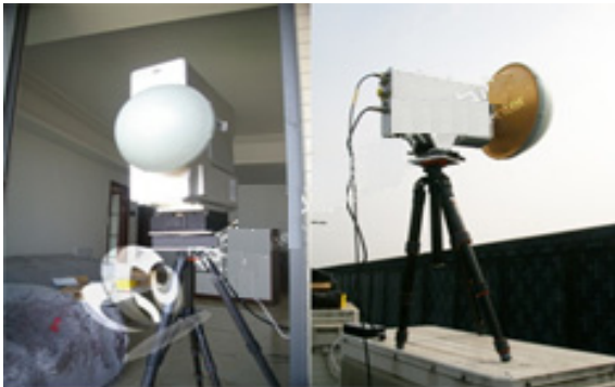
图 11 THz 远距离高速无线传输试验
